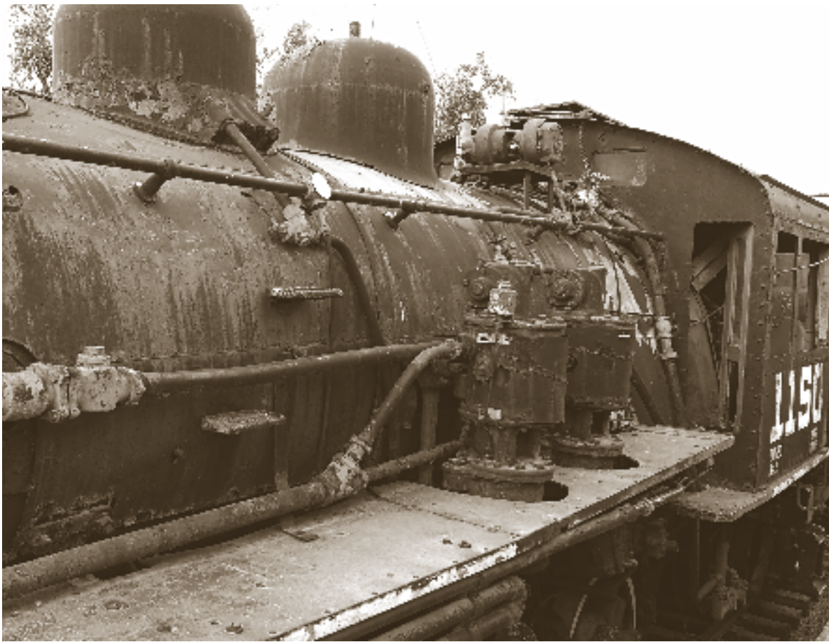
Locomotora de vapor NM 1150 antes de su restauración. Corrosión y deterioros en la pintura, 2018. Secretaría de Cultura, CNPPCF. Bruno Wilson.
